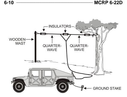
Figure 6-6. Center-Fed Doublet Antenna.
